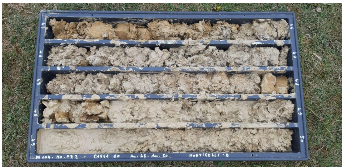
SONDAGGIO MO_PZ2: Cassa n.10 da 45.00 a 50.00 m
