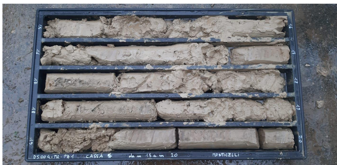
SONDAGGIO MO_PZ1: Cassa n.4 da 15.00 a 20.00 m
