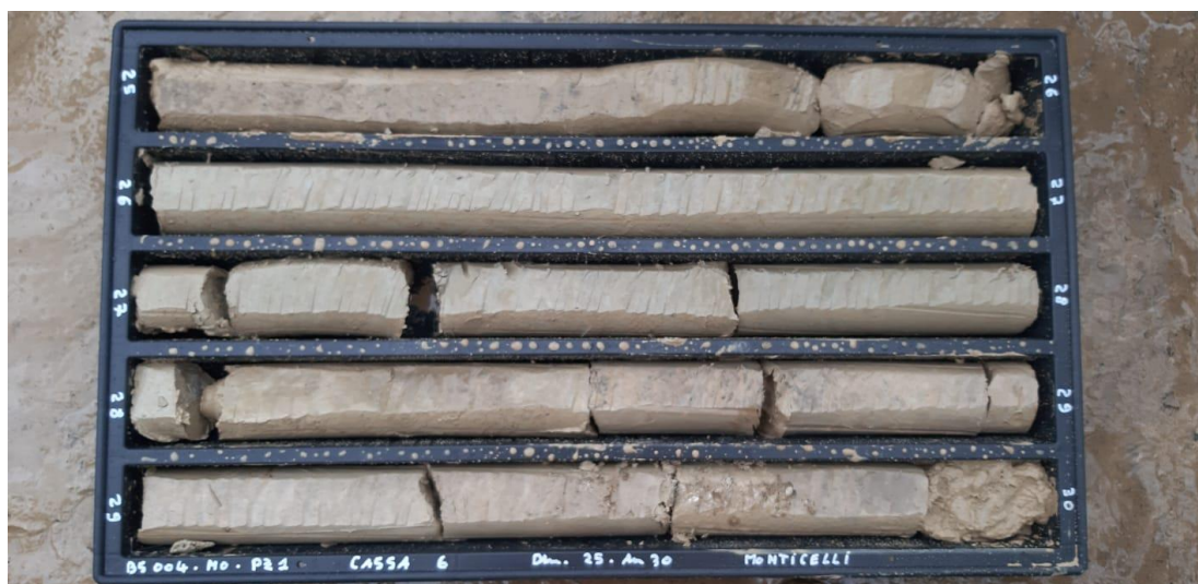
SONDAGGIO MO_PZ1: Cassa n.6 da 25.00 a 30.00 m
