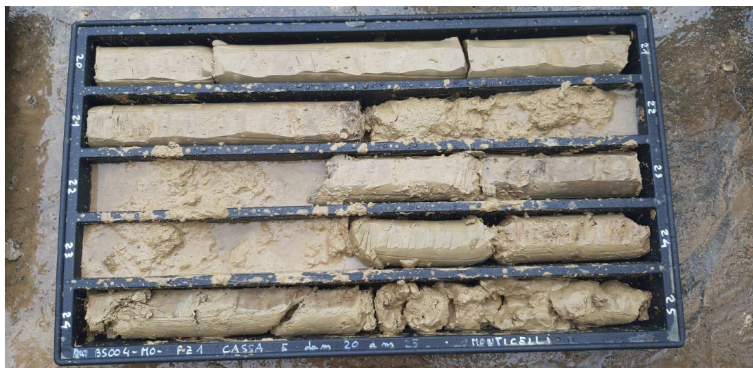
SONDAGGIO MO_PZ1: Cassa n.5 da 20.00 a 25.00 m
