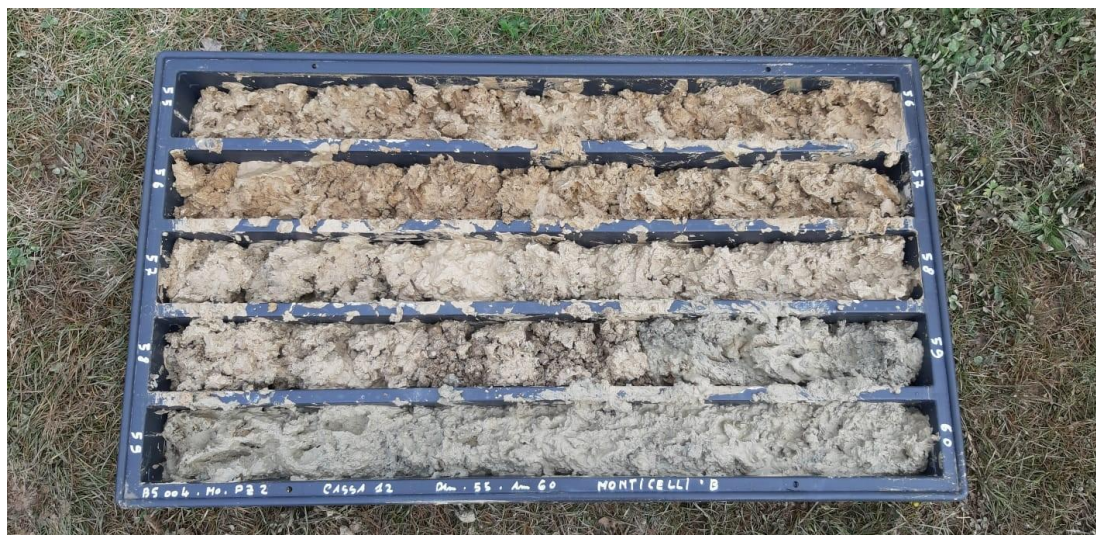
SONDAGGIO MO_PZ2: Cassa n.12 da 55.00 a 60.00 m
