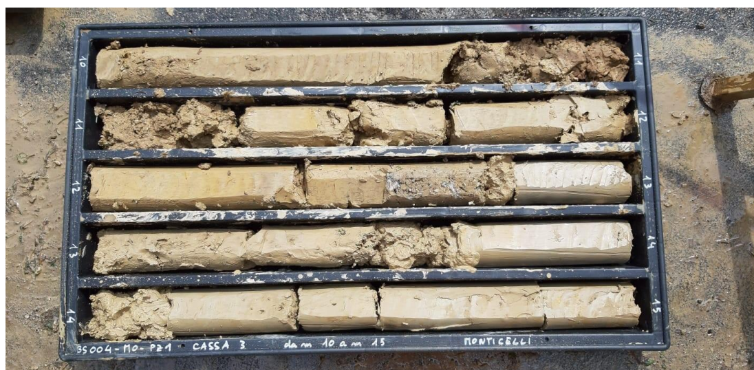
SONDAGGIO MO_PZ1: Cassa n.3 da 10.00 a 15.00 m
