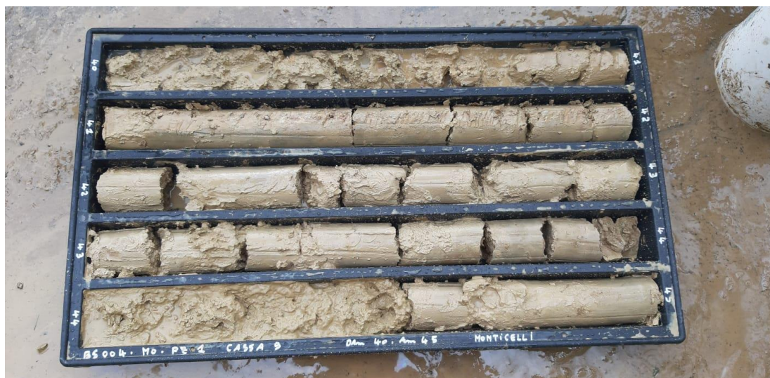
SONDAGGIO MO_PZ1: Cassa n.9 da 40.00 a 45.00 m
