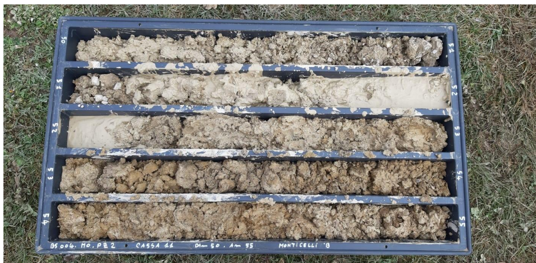
SONDAGGIO MO_PZ2: Cassa n.11 da 50.00 a 55.00 m
