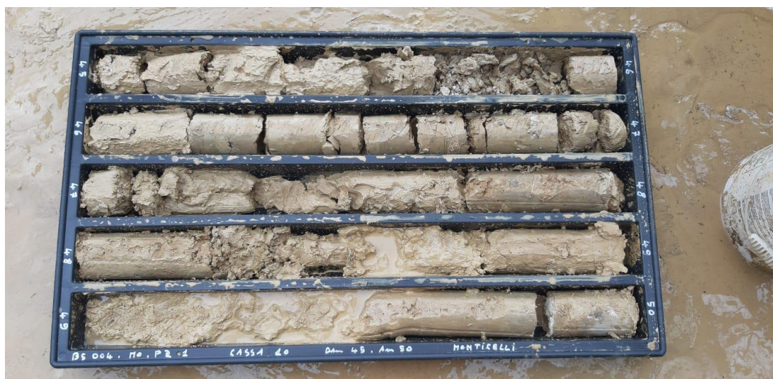
SONDAGGIO MO_PZ1: Cassa n.10 da 45.00 a 50.00 m
