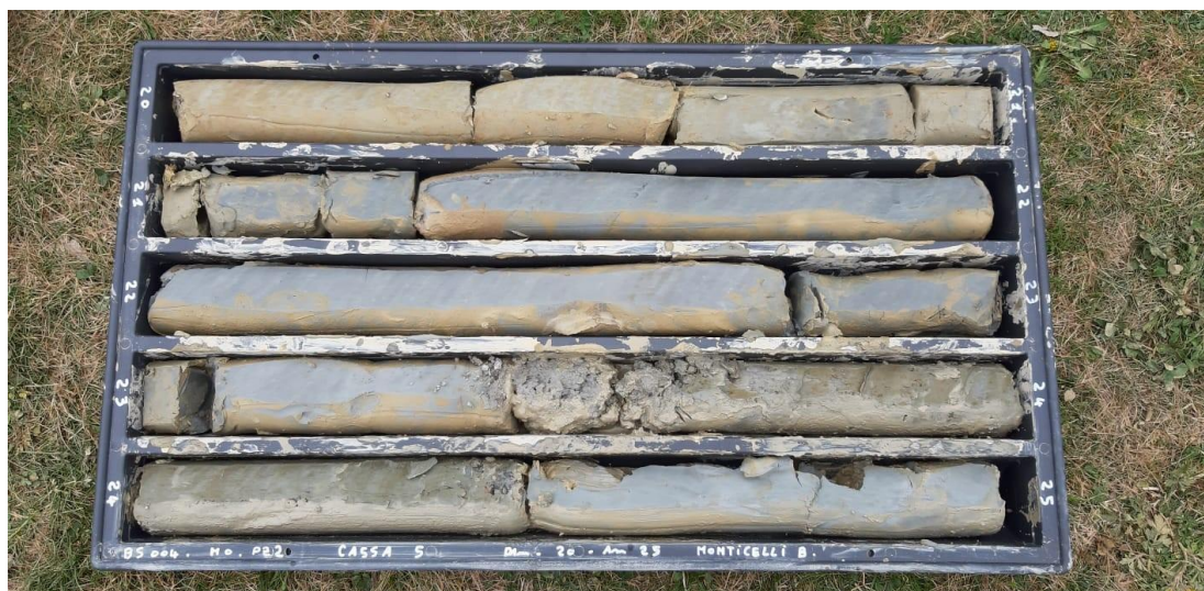
SONDAGGIO MO_PZ2: Cassa n.5 da 20.00 a 25.00 m
