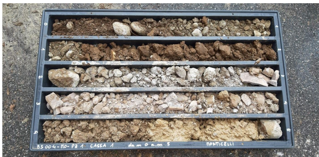
SONDAGGIO MO_PZ1: Cassa n.1 da 0.00 a 5.00 m
