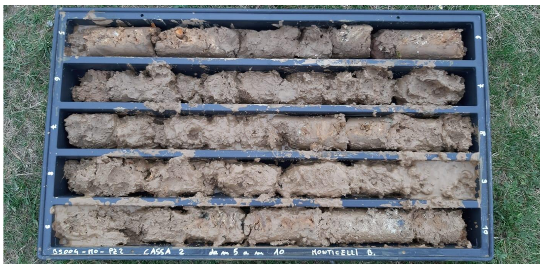
SONDAGGIO MO_PZ2: Cassa n.2 da 5.00 a 10.00 m
